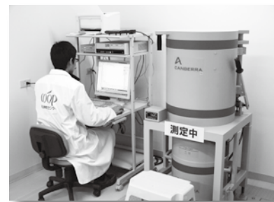
ゲルマニウム半導体検出器で計測
