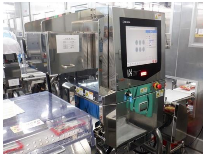
画像2: 袋詰めした後のX線検査装置 ※骨や異物をはじく
