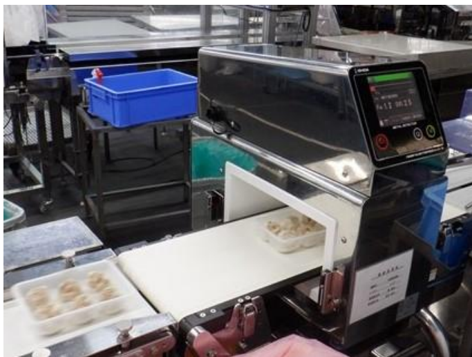
画像1: 包装工程の金属探知機 ※機械の破損などの混入を防ぐ
